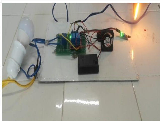
MẠCH BÁO CHÁY KẾT HỢP NGẮT MẠCH ĐIỆN, HÚT KHÓI CHỐNG NGẠT - LỚP 8/2
